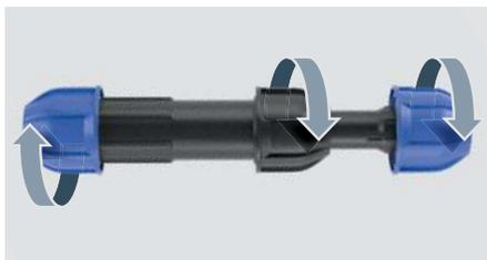
**01** Couper le tuyau selon le gabarit de coupe. Dévissez tous les écrous jusqu'au dernier filetage. Tirez les joints toriques en position détendue.
