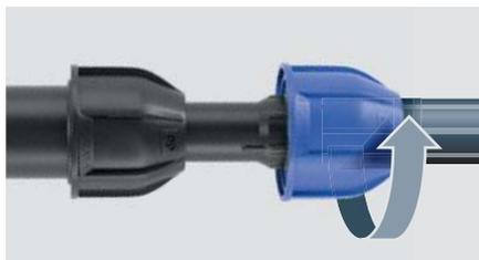
**02** Faites glisser le raccord sur le tuyau jusqu'à la longueur d'insertion maximale et serrez l'écrou.
