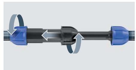
**03** Faites glisser le corps extérieur du raccord sur la profondeur d'insertion maximale jusqu'à ce qu'elle recouvre le tuyau et serrez l'écrou bleu. Serrer l'écrou noir.
