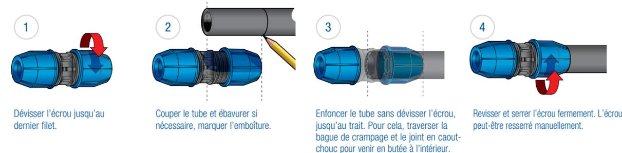
1 Dévisser l'écrou jusqu'au dernier filet.
