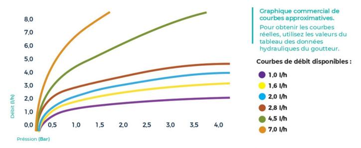
Formule de calcul du débit: Q (I/h) = K \* Pression x (Utiliser la pression en "mca" <1bar=1atm=100kPa=10mca>)
