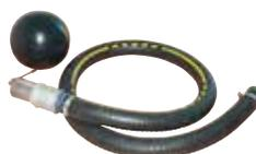
Système permettant d'aspirer l'eau d'un puits ou d'une réserve sous la surface, entre deux eaux, sans aspirer les impuretés flottantes et les eaux chargées au fond de l'installation. Ensemble composé de 2 raccords + 2 colliers inox + tuyau **TAN**. Longueur 1.50 m + crépine + boule PVC flottante.
