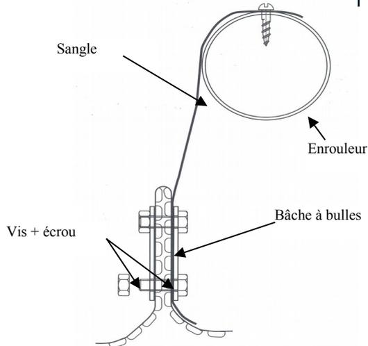
Fixez la sangle sur le tube en aluminium à l'aide d'une des vis 6 x 20 mm après avoir effectué le pré-perçage
