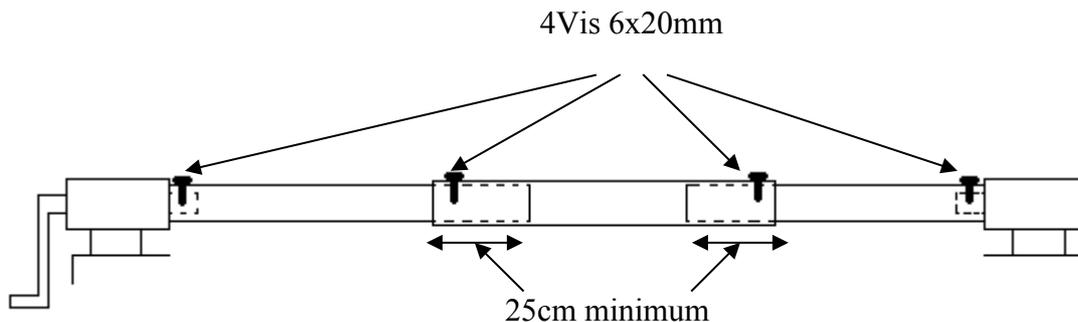
Placez tous les tubes sur le sol et introduisez les deux tubes d'extrémité dans le tube central à distance égale.
