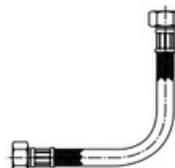
Laisser près des raccords une partie droite du tuyau d'une longueur égale au moins à 3 fois le diamètre du tube.
