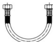
Ne pas courber le flexible avec un rayon de courbure inférieur à 3 fois le diamètre du tuyau.
