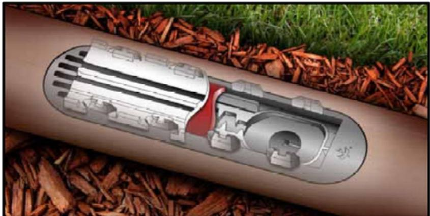
La compacité du goutteur réduit les pertes de pression, ce qui permet d'installer de plus grandes longueurs et d'obtenir un système plus rentable. Le rinçage en continu du goutteur XFD, ainsi que sa résistance au colmatage et à l'obstruction, assurent un débit constant tout en minimisant la maintenance et en générant des économies de temps et d'argent.
